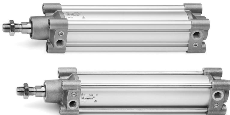
Les nouveaux vérins de la série 63, conformes au standard ISO 15552, ont été conçus pour garantir de hautes performances tout en réduisant significativement leur poids. Le nouveau système d'amortissement pneumatique et mécanique a pour objectif de réduire le bruit causé par l'impact du piston contre les fonds.
